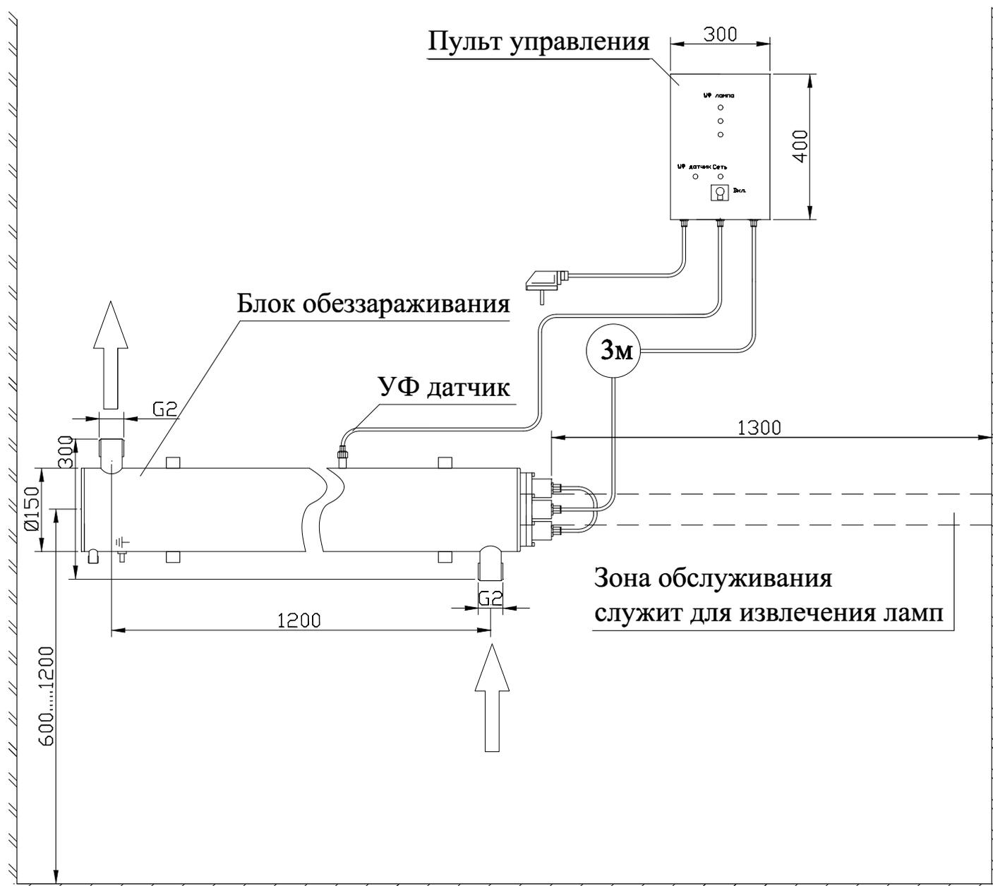
Примечание: монтаж установки к стене производится при помощи двух хомутов Ø100 мм.
